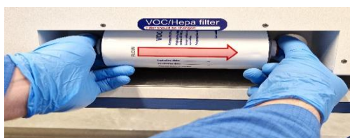
Figur 12.2 VOC/HEPA-filtrets insättnings- och borttagningsprocedur
